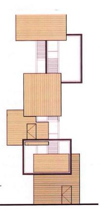
Así surge esta brre de 25 metros de alto, coronándose como el principal atractivo de la zona deportiva. La estructura diseñada y construita permanece compuesta por seis cubos, los cuales se articulan en forma aleatoria, pero siempre unidos por un núcleo constituido por columnas portantes de acero.
